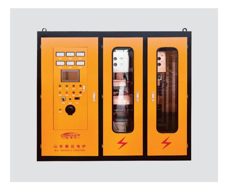
IGBT串联谐振中频电源所有器件都安装在封闭的柜子内,它的优势在于当IGBT串联谐振系统处于正常工作状态下时其整流 部分是满开的,控制的对象为逆变部分的输出功率,即IGBT串联谐振是通过调整逆变来调节中频电源的输出功率的,所以在此系 统下中频电源可以是一拖二或者一拖多。
